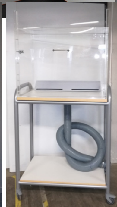
Mobile aftræksskabe giver mulighed for sikker udførelse af mere "eksplosive" forsøg. Tilkobles til eksisterende procesventilation.
